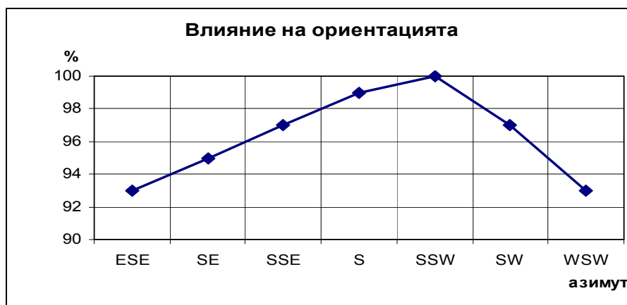
Фигура Влияние на ориентацията върху количеството на преобразуваната слънчева енергия
